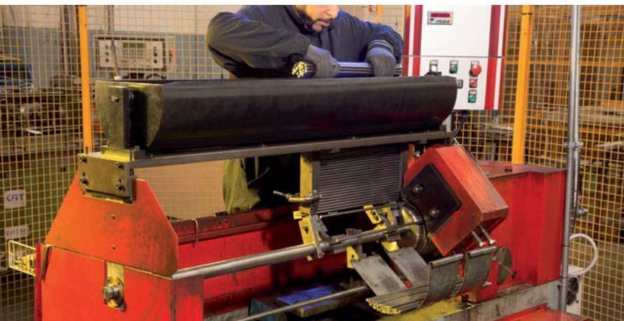
Filettatura automatica eseguita con il processo di rullatura rotativa
