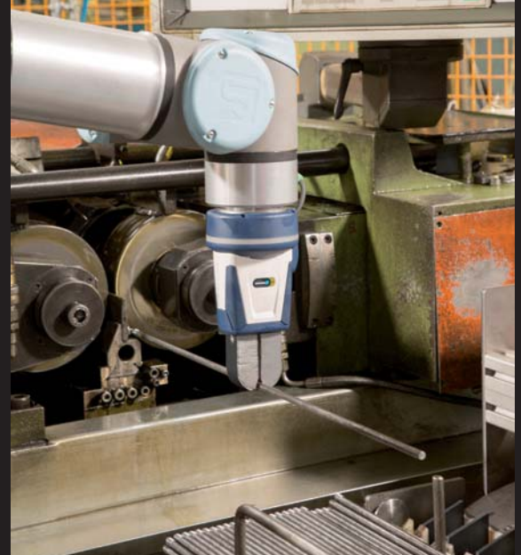
Filettatura eseguita con il processo di rullatura con carico e scarico robotizzato
